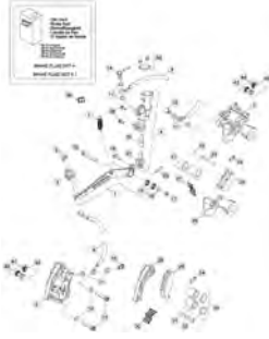
TAV.36 Impianto freni idraulici - Hydraulic brakes system - Installation des freins hydrauliques - Hidraulischebremse anlage - Instalació n freno hidrà ulico
