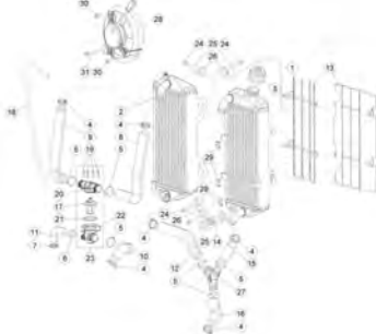
TAV.39 Impianto di raffreddamento - Installation de refroidissement - Installation de refroidissement - Kühlsystem - Instalació n de enfriamiento
