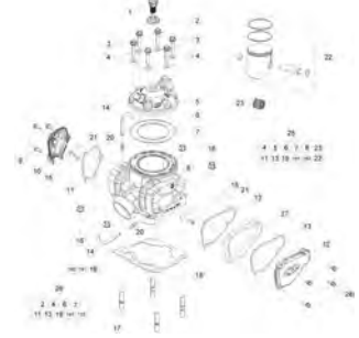
TAV.11 Cilindro completo - Cylinder, assy - Cylindre complet - Zylinder, KPL. - Cilindro completo
