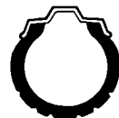
Pression trop haute
